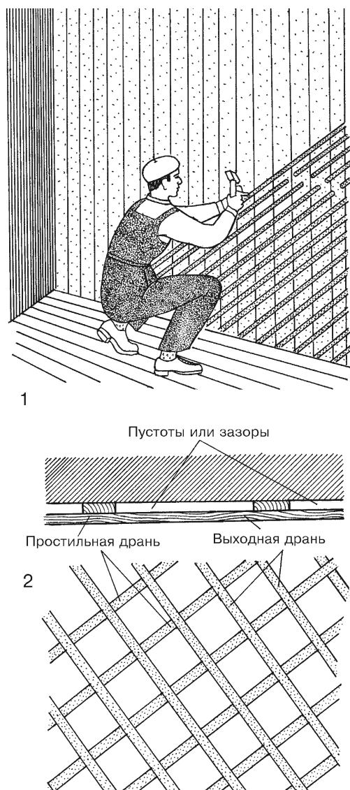
Рис. 1. Набивка драни на деревянную поверхность: 1 — техника набивки; 2 — набитая дрань
