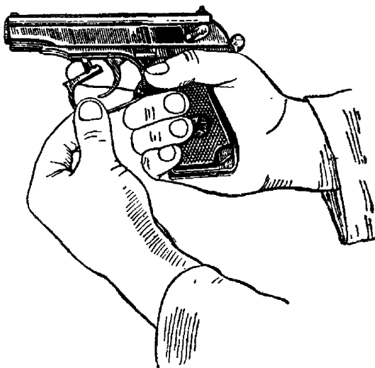
Рис. 5. Оттягивание переднего конца спусковой скобы
