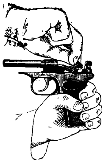
Рис. 11. Отделение шептала и затворной задержки от рамки
