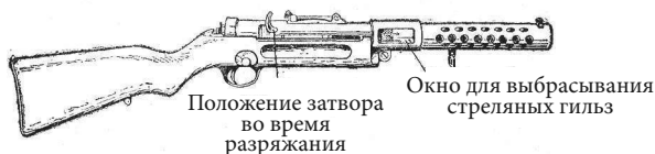
Рис. 13. Положение затвора при разряжании
