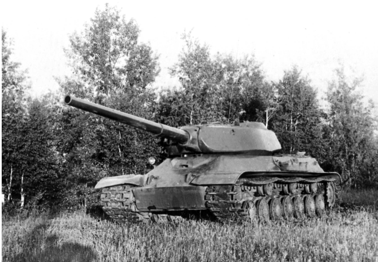
Танк «объект 701» № 1 перед прохождением испытаний. Лето 1944 года. На крыше башни видна установка 50-мм миномета С-11 (РГАЗ).
