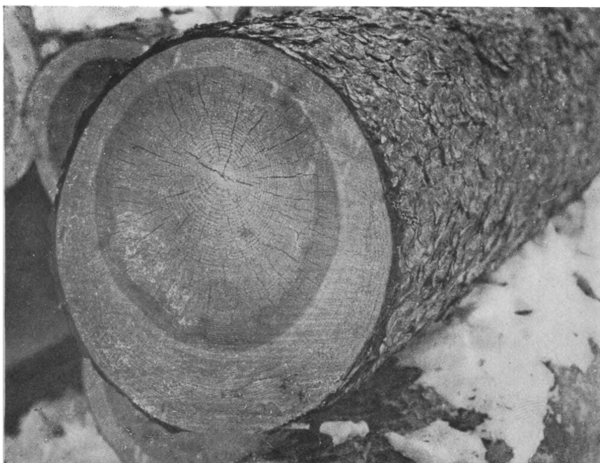
Односторонняя большеболонность соснового бревна. \frac{1}{5} натур. велич. One-sided broad sapwood in a pine log. \frac{1}{5} nat. s. Einseitige Breitsplintigkeit eines Kieferbalkens. \frac{1}{5} nat. Gr.
