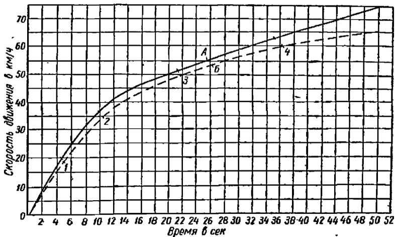
Фиг. 3. График времени разгона мотоциклов М-750 и М-72 с места с переключением передач:
