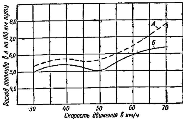
Фиг. 4. Кривые расхода топлива в зависимости от скорости движения мотоциклов М72 и К-750 на асфальтированном шоссе:
