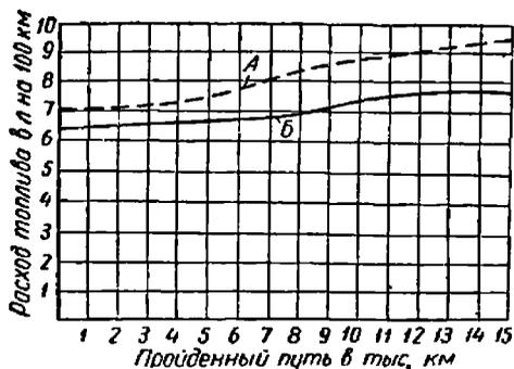
Фиг. 5. Кривые среднего расхода топлива у мотоциклов М-72 и К-750 на однотипных дорогах в зависимости от пройденного пути:
