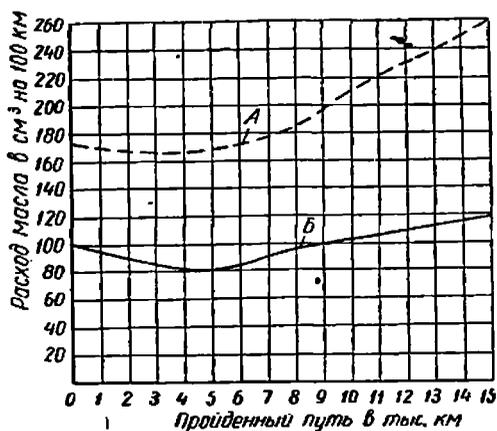
Фиг. 6. Кривые среднего расхода масла у мотоциклов М-72 и К-750 на различных дорогах в зависимости от пройденного пути:
