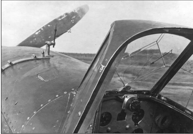
Размещение прицела ВВ-1 на самолете Ил-2:
