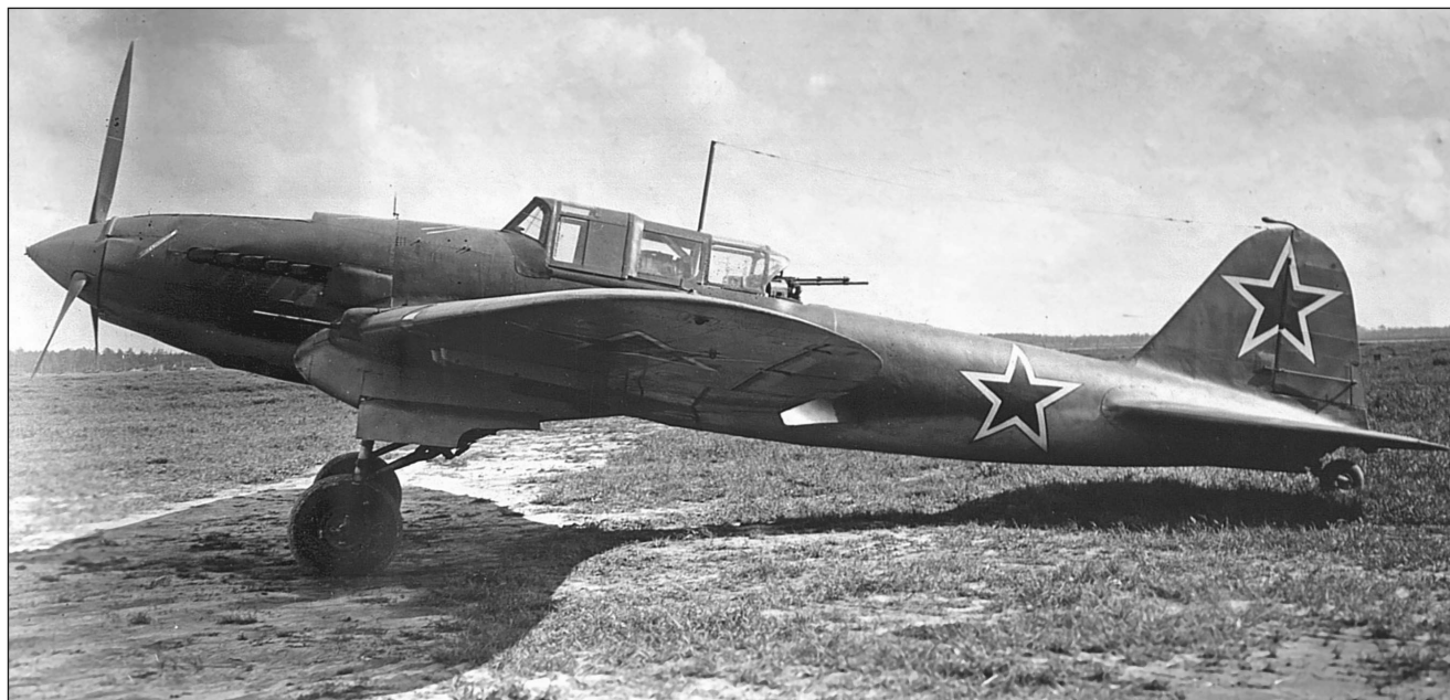
Двухместный Ил-2 зав. № 1882702 производства завода № 18 на контрольных испытаниях в НИИ ВВС, июль 1944 г. На бронекорпусе хорошо видна разметка для бомбометания с горизонтального полета и визирные штрыры.
