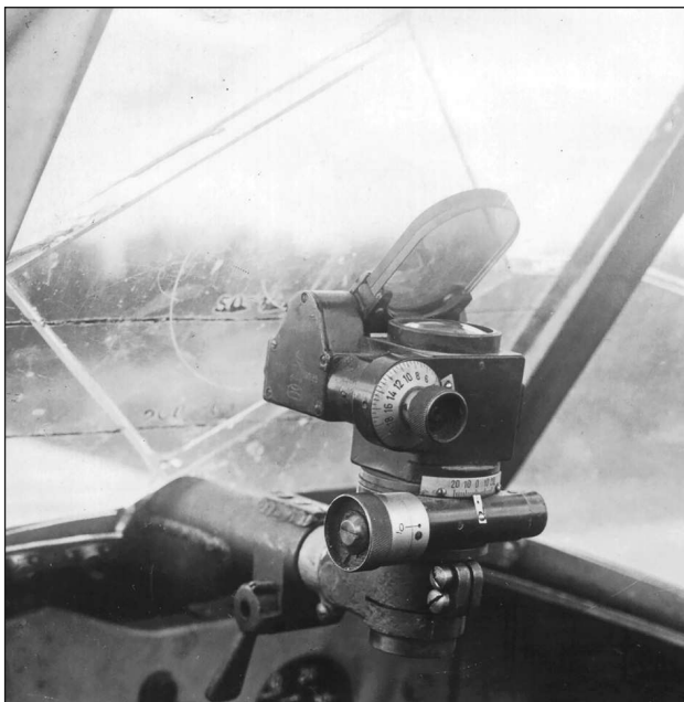
Размещение оптического прицела ПБП-1 на самолете Ил-2. С августа 1942 г. был заменен простейшим механическим прицелом ВВ-1 конструкции Васильева.
