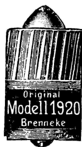
Рис. 12. Бреннеке обр. 1920 г. с твердым сердечником.
