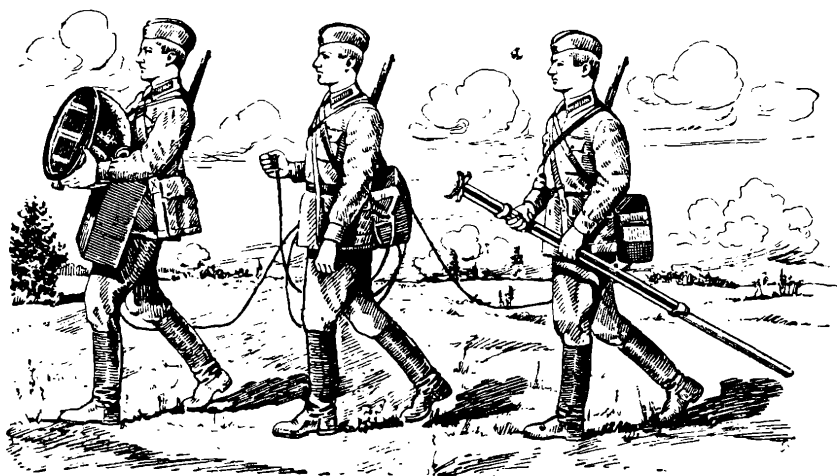
Рис. 2а. Переносная прожекторная станция (переносимая бойцами)
