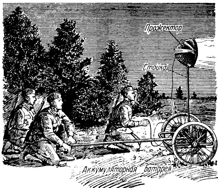
Рис. 2. Переносная прожекторная станция (на тележке)
