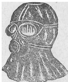
Фиг. 6. Промышленные противопыльные маски 1914—15 гг. со вставным цилиндром и клапаном (по Аркадьеву).
