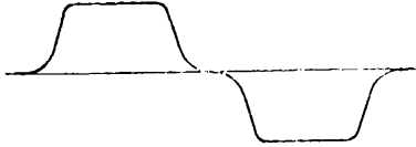
Фиг. 3. Кривая тока генератора согласно фиг. 1.
