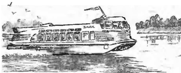
Рис. 4. «Водяной автобус» — глиссирующий 86-местный теплоход «Заря» с водометным двигателем. Технические данные: длина — 21 м, ширина — 3,65 м, осадка — 0,47 м, водоизмещение — 21,9 т, скорость — до 45 км/час.
