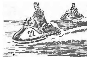
Рис. 5. «Морская блоха» — миниатюрное спортивное судно оригинальной конструкции с водометным двигателем. Длина — 2,8 м, ширина — 1,3 м, вес — 85 кг, скорость — до 50 км/час.
