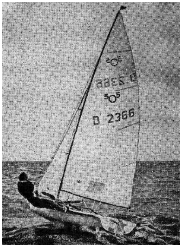
На этом фото швертбот «5-0-5» идет в лавировку. За счет небольшого крена на подветренный борт сократилась площадь смоченной поверхности
