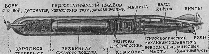
Основные части торпеды (разрез).
