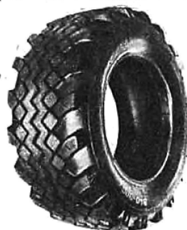
Рис. 1. Шина 940×300 модели В-20.
