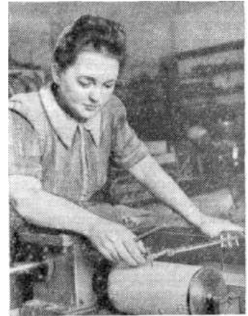
Кандидат технических наук К. С. Гаевская у динамографа. Она определяет дуговое усилие ковша при резании грунта.
