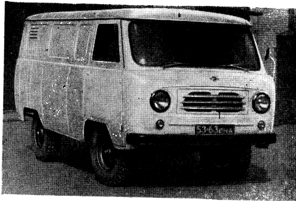
Рис. 4. Авторефрижератор ЛуМЗ-946 с машинно-аккумуляционной системой охлаждения.
