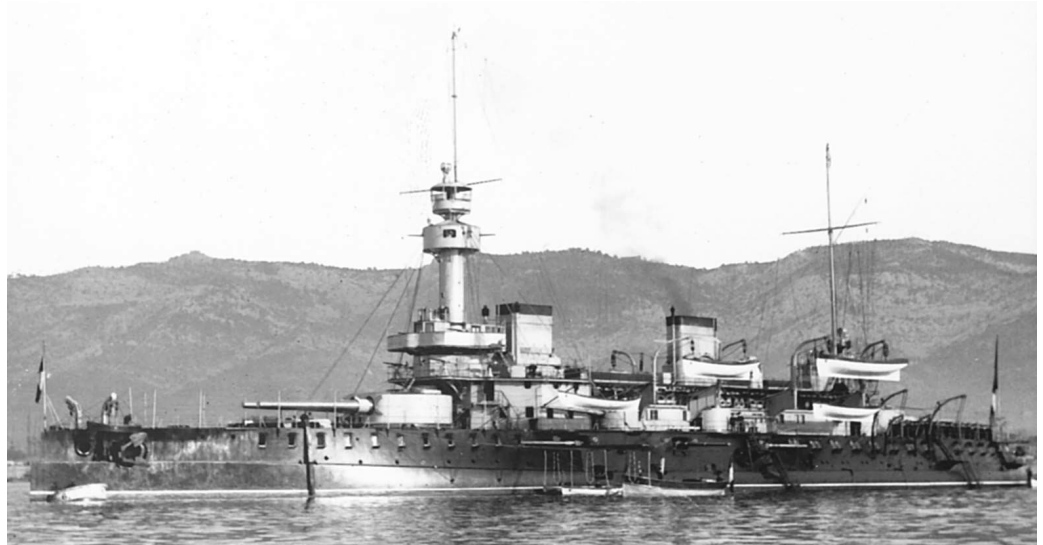
Броненосец «Бреннус» нес три 340-мм орудия главного калибра в двухорудийной башне на носу и одноорудийной на корме
