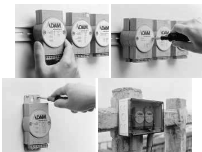
Рис. 1.3. Внешний вид модулей серии ADAM-4000 и способы их установки
