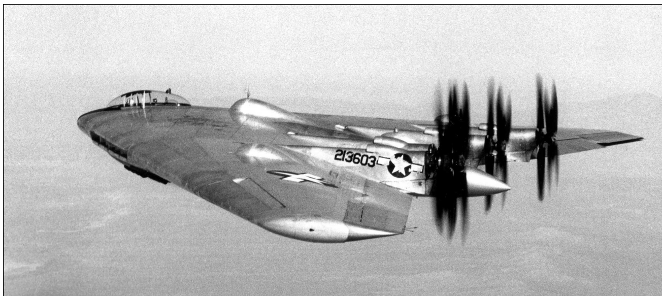
Летающее крыло фирмы «Нортроп» — XB-35. Каплевидный фонарь кабины пилотов обеспечивает круговой обзор. Моторы имеют соосные винты. Функцию кия выполняют большие мотогондолы моторов.
