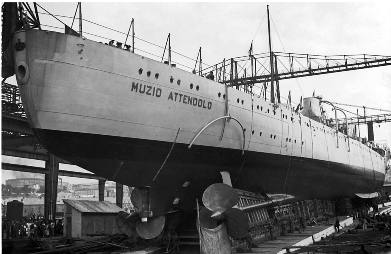
Корпус крейсера «Муцио Аттендоло» на стапеле верфи «С.Р.Д.А.» в Триесте незадолго до спуска на воду, сентябрь 1934 г. Хорошо видна форма форштевня с бульбообразным утолщением, а также гребные валы и винты
