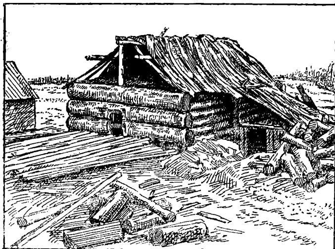
Рис. 5. Вид парни для пропарки ползьев
