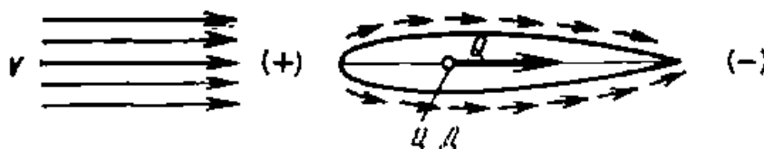
Рис. 19. К возникновению профильного сопротивления
